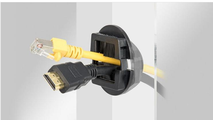
Für runde metrische M32/M50 Ausbrüche bietet icotek die teilbare Kabelverschraubung KEL-BES-S rund an. Diese kann direkt in den Ausbruch eingerastet oder mit einer Gegenmutter (im Lieferumfang enthalten) verschraubt werden.
